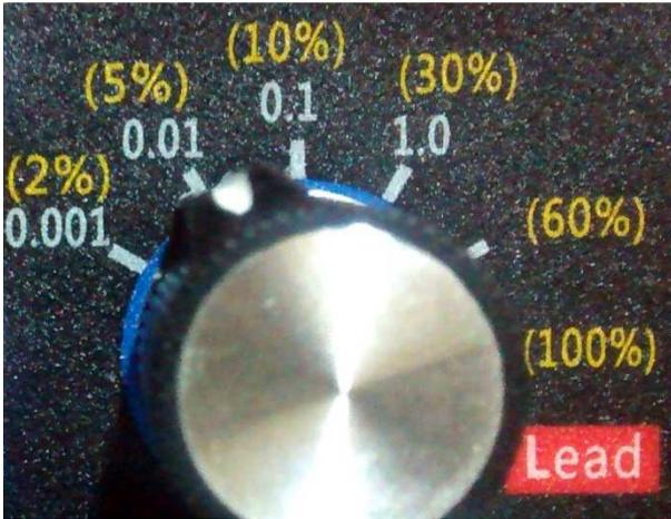
Mithilfe diesen Schalters können Sie die Schrittweite oder Geschwindigkeit beim Drehen des Handrades einstellen.
