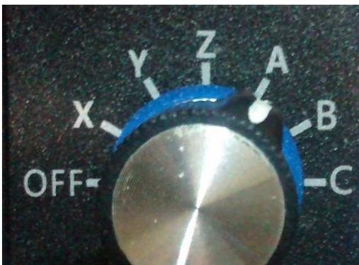
Mit Hilfe diesen Schalter wählen Sie die Achse aus, mit der verfahren werden soll.
