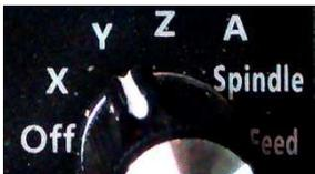
Drehen Sie den Drehschalter rechts unten auf die Stellung für die Achse, die sie bewegen möchten. Die Achse folgt jetzt der Bewegung des großen Rads mit Kurbel und Skala. Auflösung und Geschwindigkeit können mit der Taste „STEP ++“ umgeschaltet werden. Die Einstellung der auswählbaren Schrittweiten erfolgt im Menü „Konfiguration – Maschine“ auf der Seite „Geschwindigkeiten“ bei „Handrad“, rechts.
