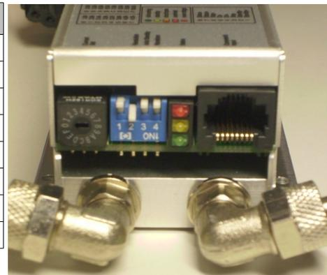
**Achtung:** Stellen Sie unbedingt den richtigen Phasenstrom ein, bevor sie das Netzteil einschalten. Ein zu hoher Strom – auch nur kurzzeitig – kann den Motor beschädigen. Wenn sie nicht das volle Drehmoment des Motors benötigen, können sie auch einen etwas niedrigeren Strom einstellen. Dies vermindert die Wärmeentwicklung deutlich. Stellen sie jedoch nicht weniger als 70% des Nennstroms ein, sonst läuft der Motor unter Umständen nicht richtig „rund“.
