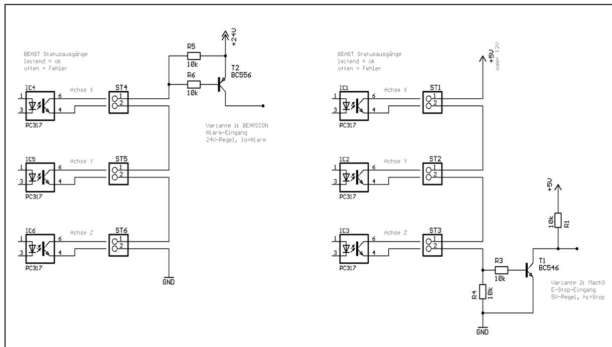
Das obige Bild zeigt zwei Schaltungsbeispiele, eines für 24V-Pegel (z.B. SPS-Systeme) und eines für 5V-Pegel (PC Parallelport, Mach3 ohne Breakoutboard oder von anderem Hersteller). Die Statusausgänge der BIGBEAST-Endstufen werden dabei in Reihe geschaltet. Ein Fehler mindestens einer Endstufe, die Unterbrechung eines Kabels oder ein Spannungsausfall führt dabei sicher zu einer Alarmmeldung an die Steuerung.
